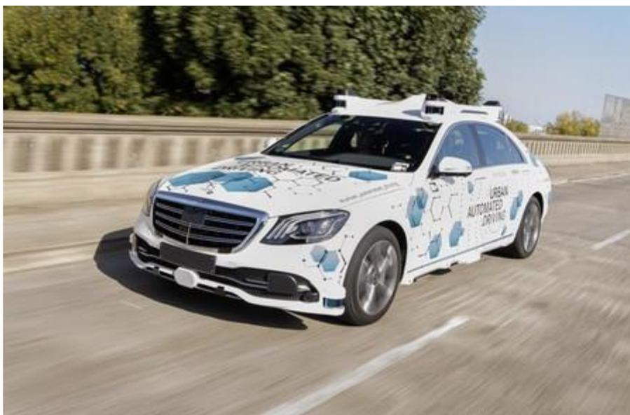
*Figura 6. Vehículo equipado con sensores LiDAR en el techo. Fuente [13].*
