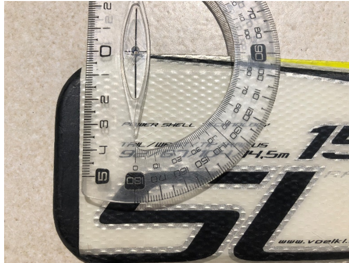
Figura 28.- Mesura de l'angle de divergència.
