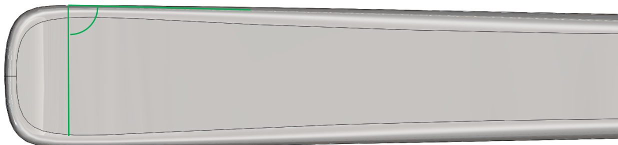
Figura 9.- Esquema de l'angle de divergència d'un esquí.
