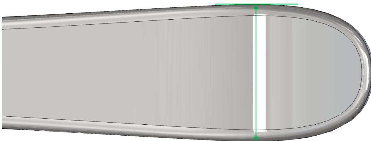
Figura 12.- Esquema de l'amplitud de la punta d'un esquí.
