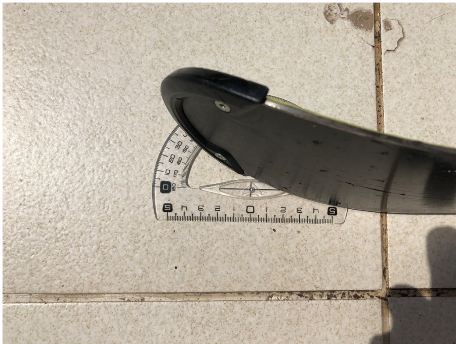
Figura 29.- Mesura de l'angle de sortida de la punta.
