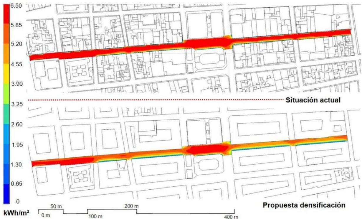
Figura 4.41. Resultados de la simulación de radiación solar que recibe la calle Monterrey (ew.4) durante la temporada de calor.
