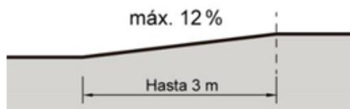
**Figura 9-3:** Pendiente longitudinal de hasta 3 metros
