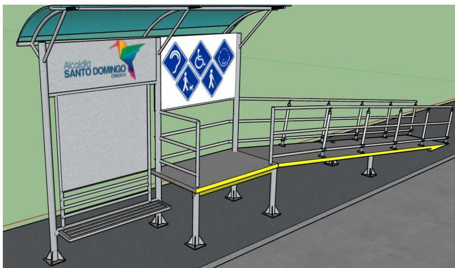
**Figura 10-3:** Diseño de las paradas inclusivas
