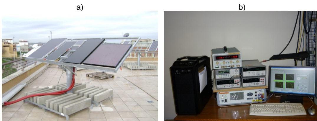
Figura 9. Instalaciones de los especímenes FV investigados: a) módulos de los cuatro materiales fotovoltaicos estudiados, hospedados en las instalaciones de la UJA y b) SAD para los módulos FV de LD. Esta configuración experimental permite el trazado de curvas I - V junto con la adquisición de las variables medioambientales bajo cuya influencia dichas curvas son capturadas.
