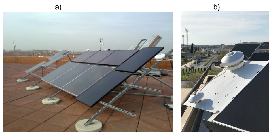
Figura 7. Instrumentos de medida de irradiancia de banda ancha y espectral utilizados en los dos enclaves considerados: a) espectrorradiómetro y piranómetro emplazados en ambos extremos superiores de la estructura metálica, ubicados en Madrid y b) espectrorradiómetro y piranómetro ubicados en Jaén.
