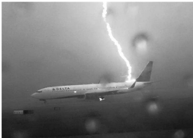
Рис. 1. Поражение самолета молнией при рулении Fig. 1. Lightning strike of the aircraft during taxiing
