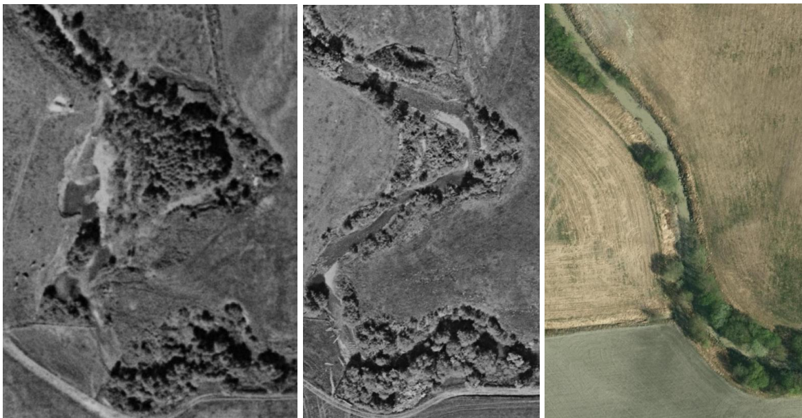
Bilde 38. Flyfotoserie fra parti i Leirbakkens anadrome strekninger ovenfor Fv. 65. Flyfoto fra 1957 (t.v.) og 1962 (midten) viser naturtilstanden, med svært egnede vassdragskvaliteter for laksefisk, og 2013 (t.h.) en utrettet, senket kanal som har mistet alle naturlige egenskaper. Flyfoto: https://kart.finn.no/
