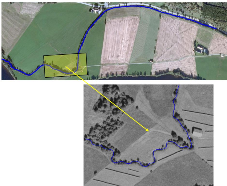
Bilde 88. Flyfoto over nedre anadrom strekning i Vigda (øverst), som er svært endret sammenlignet med naturtilstand. Noen få strekninger av bekken var fortsatt bevart i 1937 (nederst), med relativt intakt meandrering og variert bekkeløp, som er Vigdas naturtilstand. ( https://kart.finn.no/ ).
