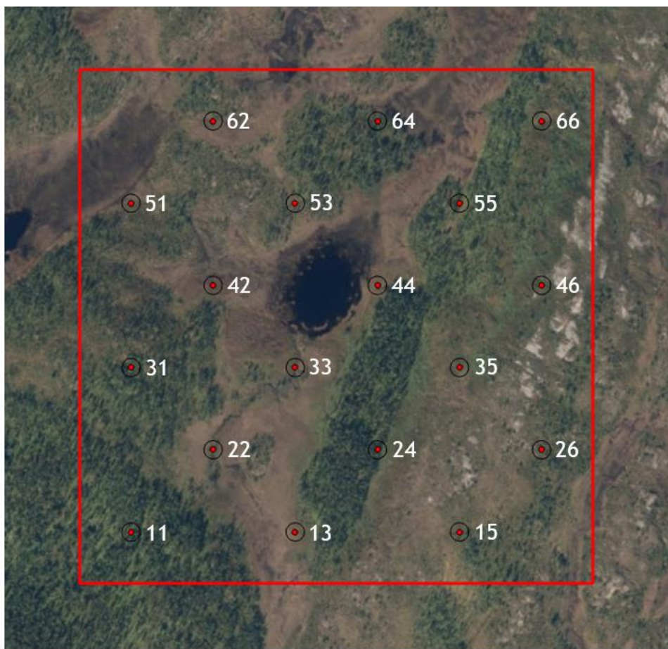
Figur 3. Eksempel på ANO-flate med 18 ANO-punkter og sirkler i regulært forband. (Etter vedlegg C – i feltinstruksen for ANO).
