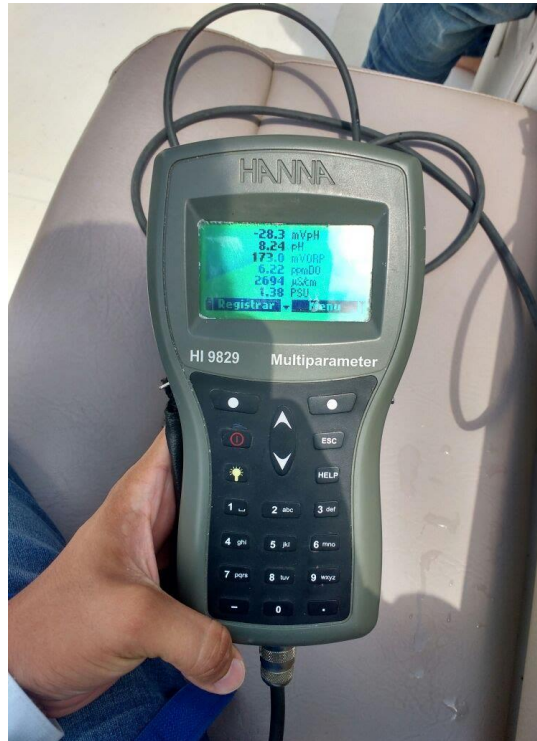
Sonda multiparamétrica HANNA modelo HI 9829
