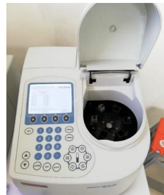
Espectrofotómetro Génesis 10S UV-VIS marca Thermo Scientific.
