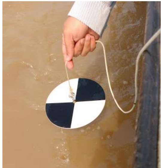
Determinación de transparencia del agua con el Disco Secchi.
