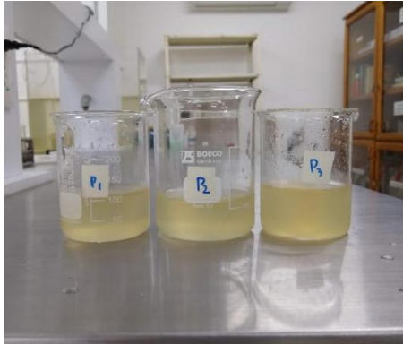
Preparación de muestras para la determinación de clorofila-a.
