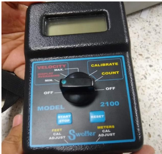
Micromolinet hidrométrico Swiffer modelo 2100.
