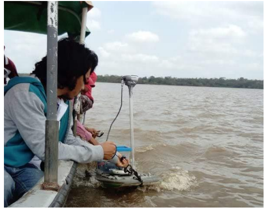
Toma de datos batimétricos con ADCP.
