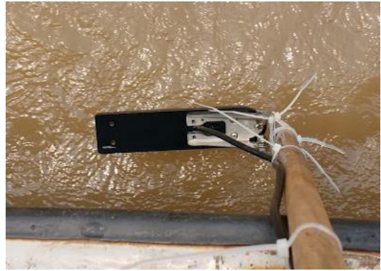
Toma de datos batimétricos con la GPS/Ecosonda Garmin echoMAP 73sv.
