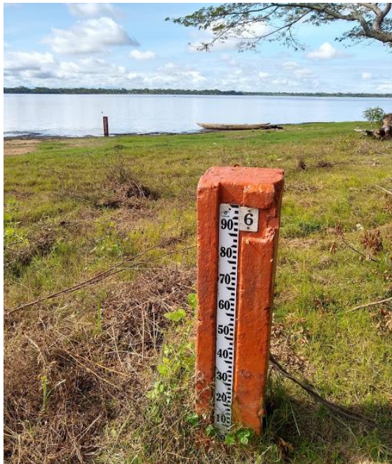
Mira - estación limnimétrica Maracayo.
