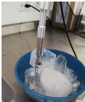
Sonicación de las muestras en baño de hielo.
