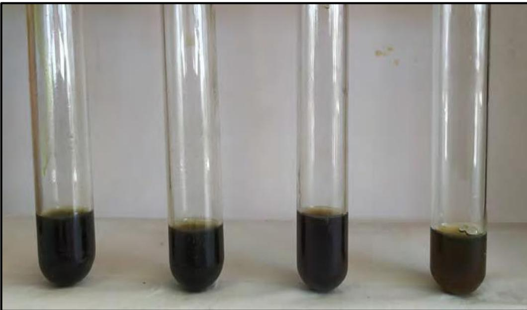
Ilustración 8. Cloruro Férrico (A, E, N, T de izquierda a derecha).
