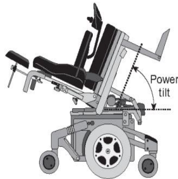
Şekil 2.4 Orta tekerlek sürücü ETS [79].
