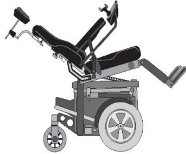
Şekil 2.3. Ön tekerlekten çekiş ETS [79].
