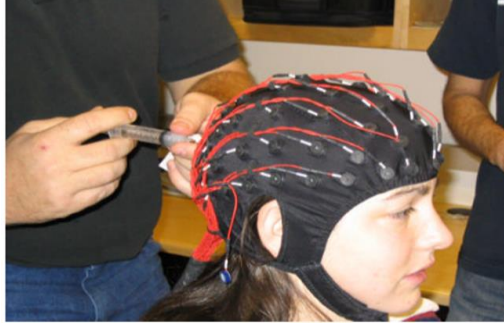
Şekil 2.14. EEG kepi ve jel enjeksiyonu gösterimi [94]
