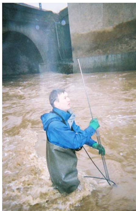
Figure V - 40 : Jaugeage du Riou Viou au site du MOULIN, le 9 janvier 2004.
