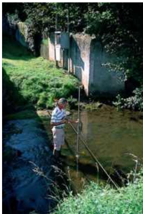
Figure V - 39 : Transect sur la rivière pour la mesure de débit (photo DIREN) – Calendrier des jaugeages réalisés sur le Riou Mort à FIRMI et le Riou Viou au MOULIN.
