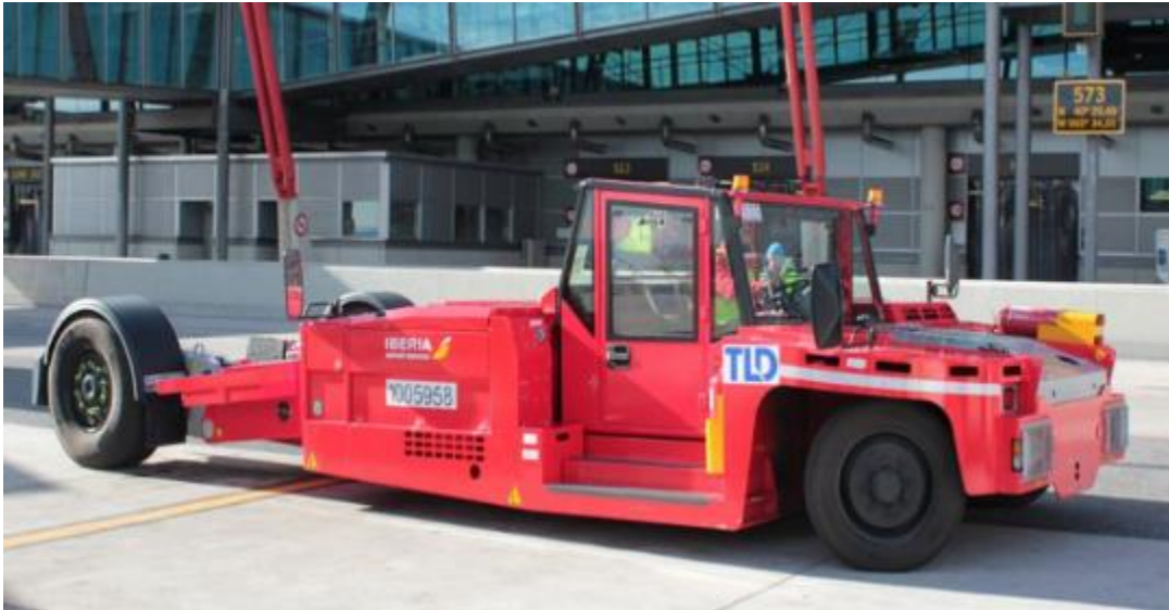
Ilustración 1 Push - back TLD con motor diésel de 300 CV
