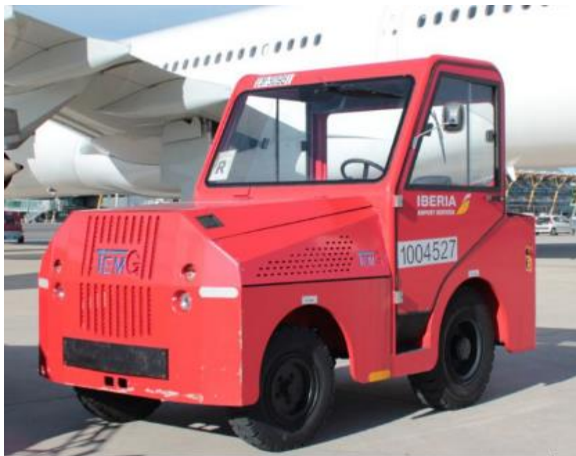
Ilustración 2 Cabeza tractora de 75 CV
