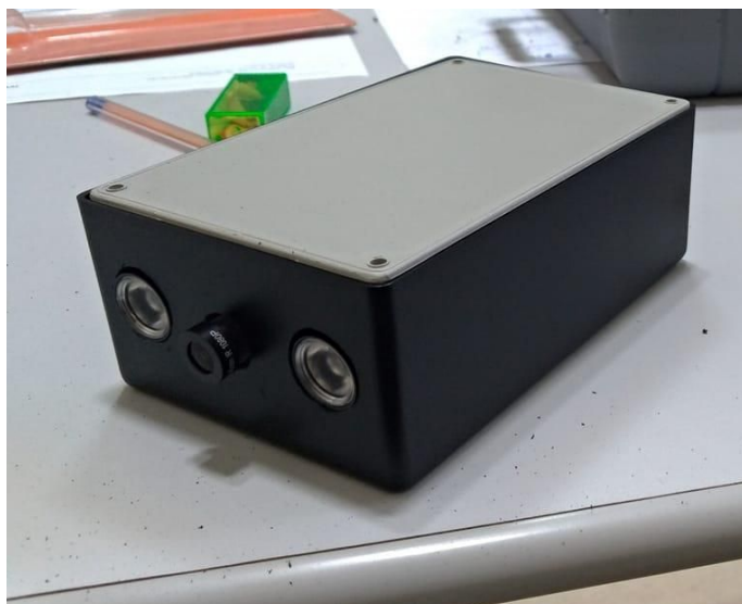
Figura 1. Câmera do sistema embarcado: Raspberry PI com câmera acoplada (Raspberry Pi Camera v.1 NoIR infravermelho) e LED de infravermelho adaptados.
