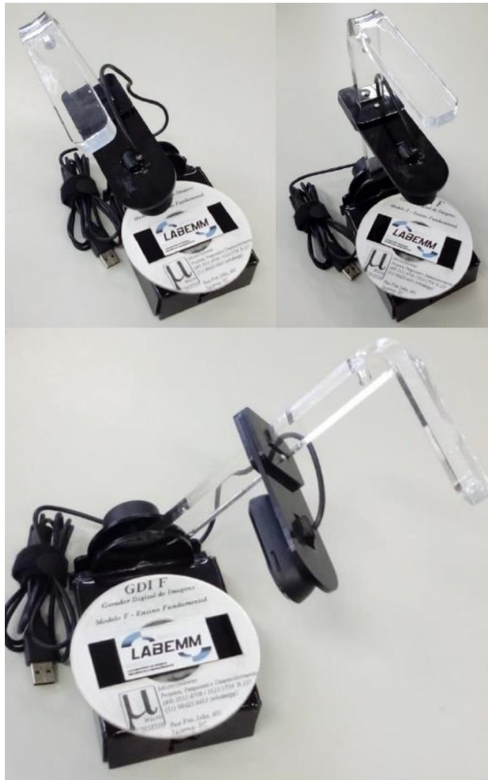
Figura 02 - Protótipo do microscópio óptico portátil. Fonte: O autor (2019).
