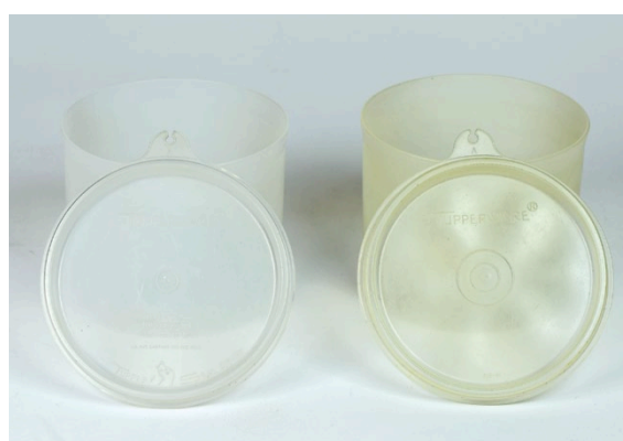
Abb. 3: Deckel der Tupperware-Dosen im Vergleich. Während der linke Deckel aus den USA plan liegt, hat sich der rechte Deckel aus Belgien verzogen. Inv.-Nr. K-2016-00693 und K-2016-0069. Foto: Laura Bode © Deutsches Kunststoff-Museum, Oberhausen
