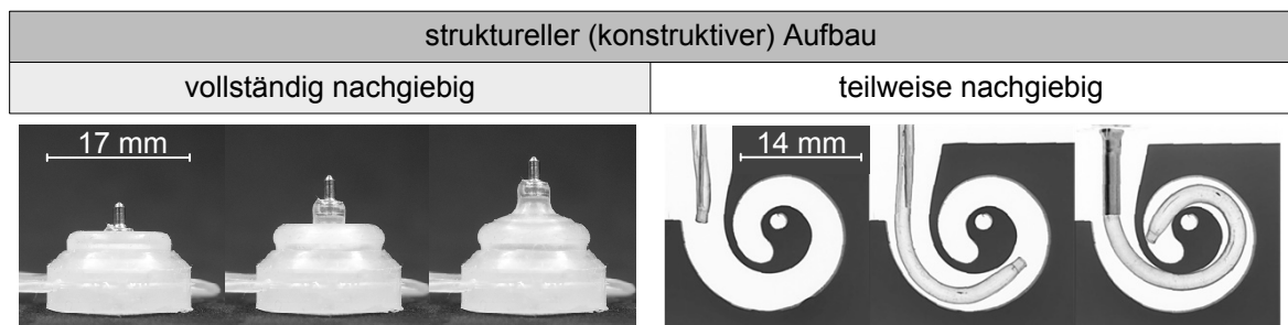
Abbildung 2.3: Einteilung der FNA nach ihrem strukturellen Aufbau, links: FNA mit EEG-Elektrode zur Durchdringung der Haarschicht [77, 104]; rechts: FNA als Elektrodenträger zusätzlich relativ beweglich gegenüber einem starren Hohlstilet [97, 98, 283]
