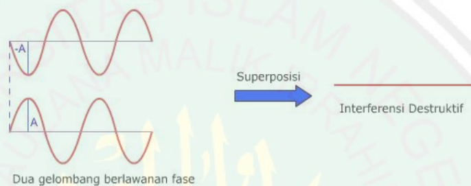
Gambar 2.6 Hasil Gelombang Interferensi Destruktif (Sumber: Halliday, 2013)
