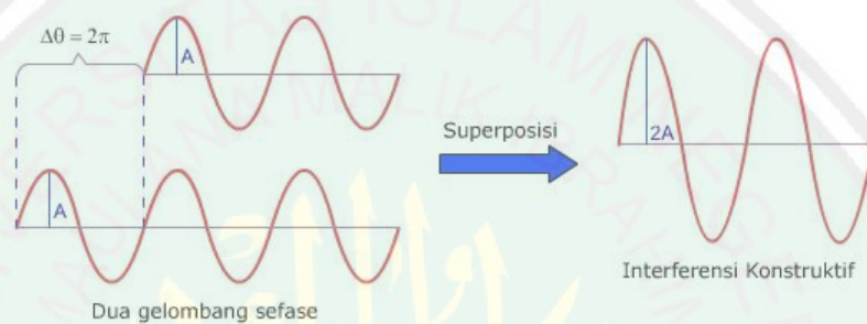
Gambar 2.5 Hasil Gelombang Interferensi Konstruktif (Sumber: Halliday, 2013)
