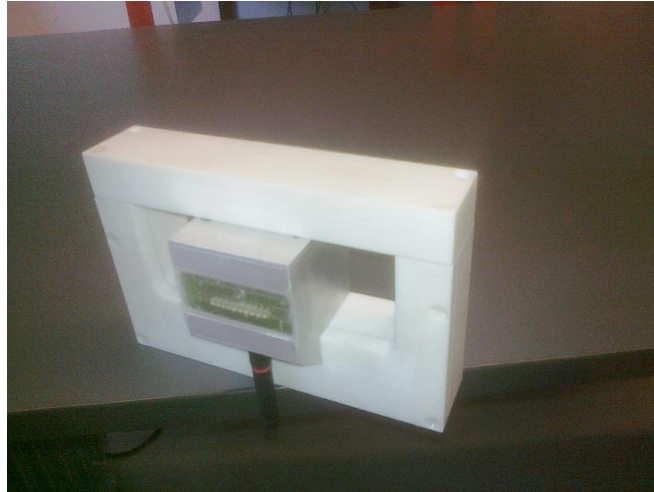
Figura 5.6 – Fotografia do sistema com o transformador de corrente e a unidade electrónica.
