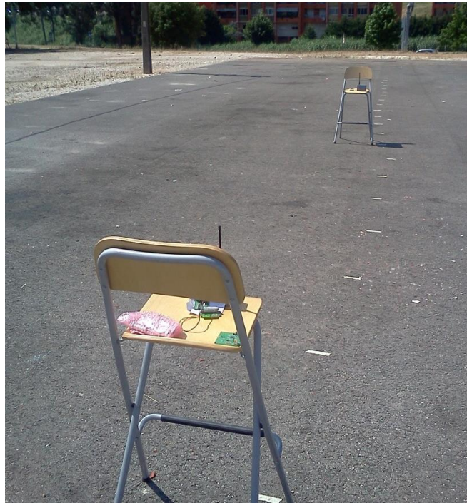
Figura 6.10 – Montagem experimental dos testes do sistema de despertar selectivo no exterior.
