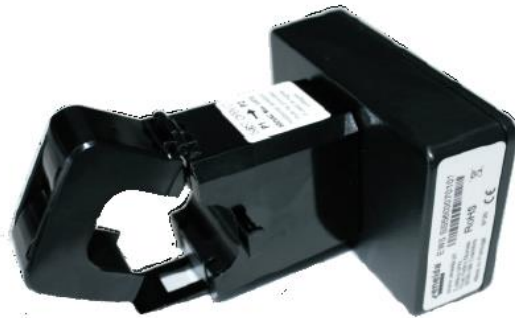
Figura 5.11 – Fotografia do sensor de monitorização de corrente DTTI-reh.
