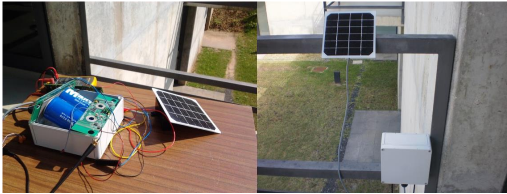
Figura 3.16 – Fotografias do repetidor R433M-ehEX em teste laboratorial (lado esquerdo) e como produto final (lado direito).
