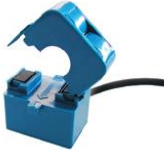
Figura 5.2 – Imagem do transformador de corrente TT 100-SD utilizado no teste de prova-de-conceito.
