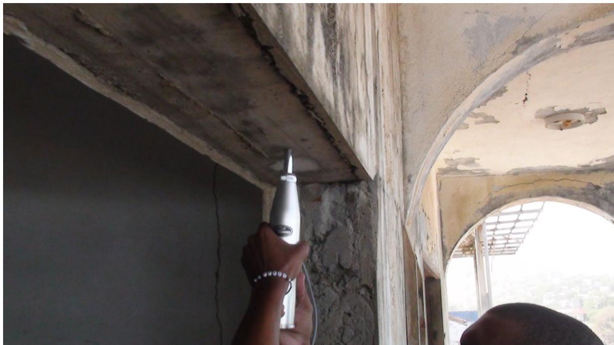
Figura 36 - Ensaio de esclerómetro feito a uma viga [fonte: o autor]
