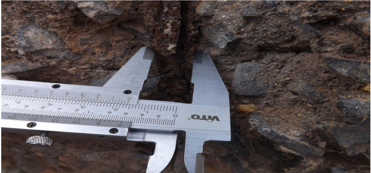
Figura 40 - Medição de um aço oxidado.[fonte: o autor]
