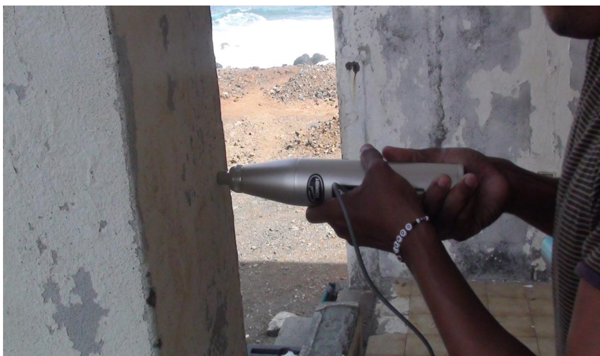
Figura 35 - ensaio de esclerómetro feito a um pilar [fonte: o autor]
