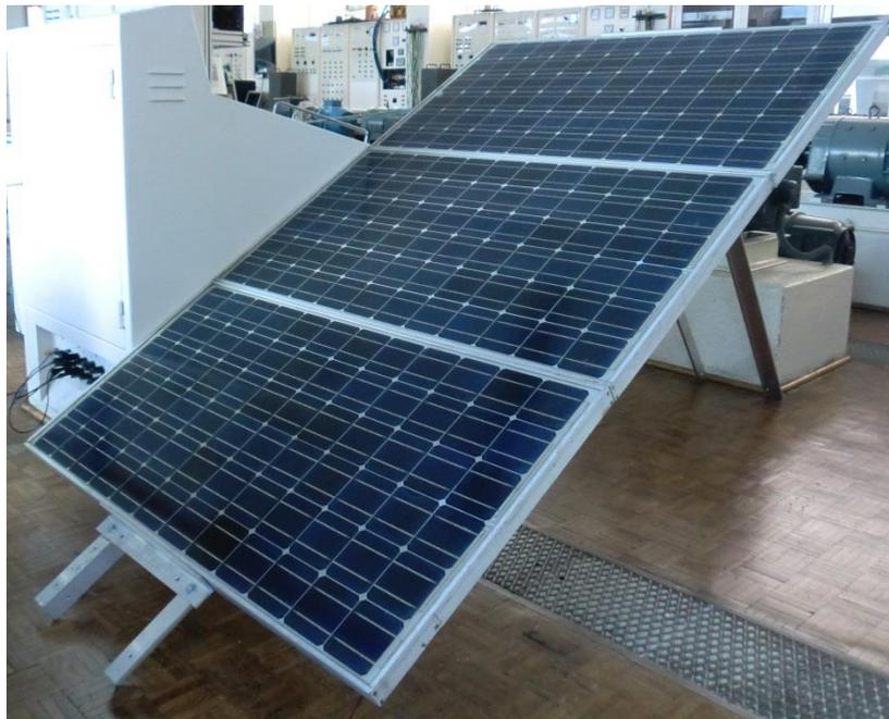
Figura 5.1 – Estrutura do *string* constituído por três módulos solar SM110
