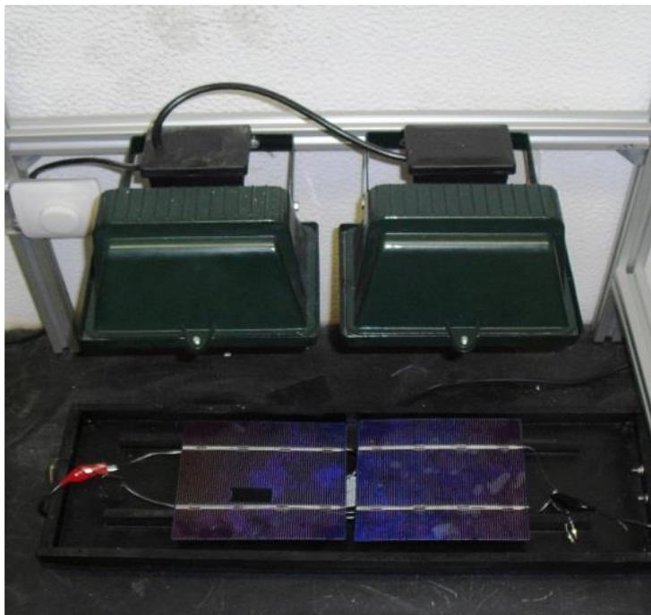
Figura 4.1 – Montagem experimental para o estudo do efeito da temperatura nas células PV.
