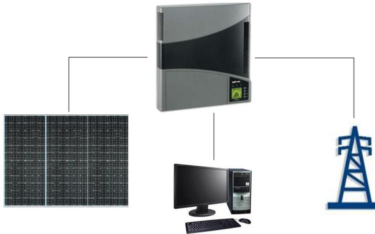
**Figura 5.5 - Esquema de um sistema fotovoltaico ligado a uma rede eléctrica**
