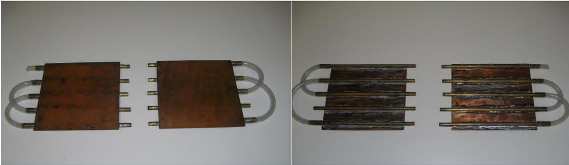
**Figura 4.12 - Fotografia do sistema de refrigeração realizado: serpentina de cobre**
