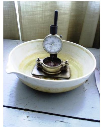
**Ensaio de expansibilidade do solo (Deflectómetro)**
