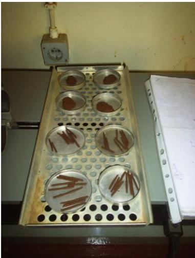
**Amostras para a determinação de limite de plasticidade**
