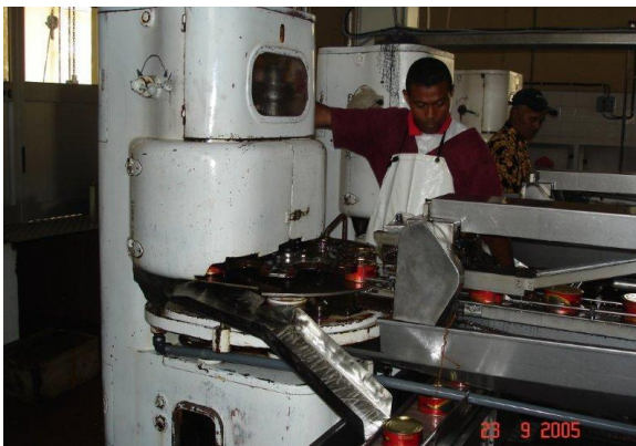
Fotografia 2.7. Colocação da tampa
