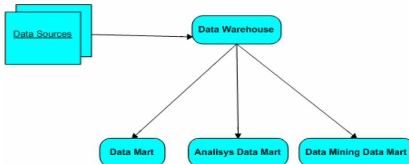
Esquema 8 - Data Mining utilizando Data Warehouse
