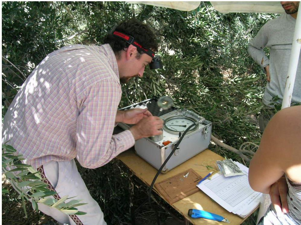
Foto 2.2. Las medidas de potencial hídrico xilemático fueron realizadas al mediodía solar, en condiciones de cielo despejado, con una cámara de presión con un rango de 0-8 MPa.
