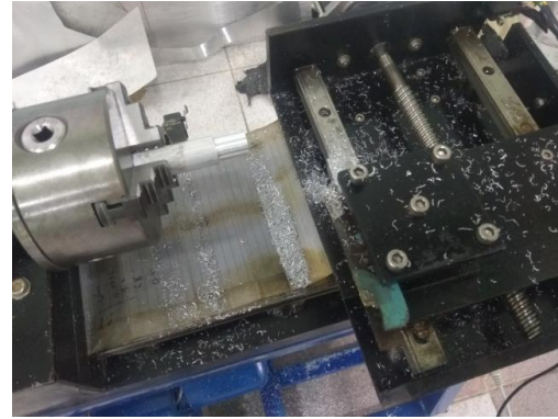
Gambar 8. Percobaan pembubutan alumunium
