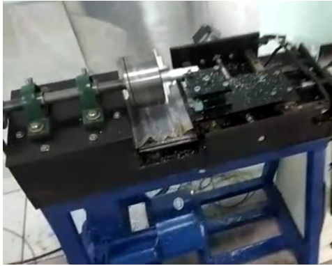
Gambar 8. Percobaan pembubutan alumunium
