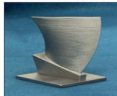
(d) Turbine Blade using LENS
