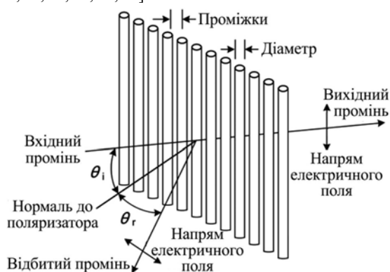
Рис. 1. Схематичне зображення поляризатора на підставі дрітчастих сіток [31]
