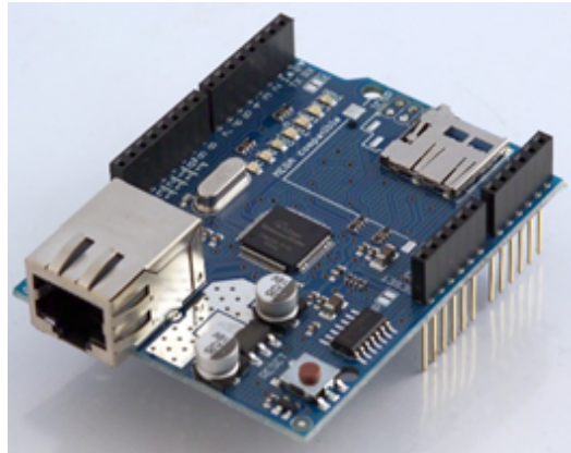
Fig. 3.7: Sistema Embebido Ethernet Arduino [29]
