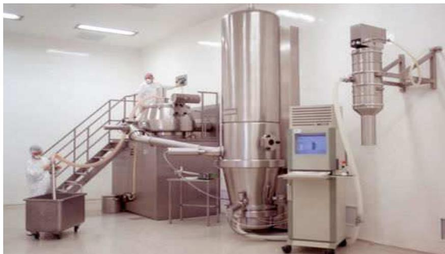
*Figura 2. Secador de Lecho Fluidizado.*
