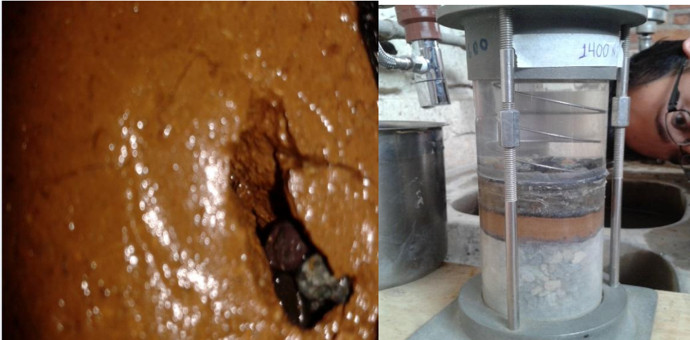
Foto 3. 1 Hueco en la muestra del ensayo correspondiente al geotextil NT-1400 y foto del ensayo.
