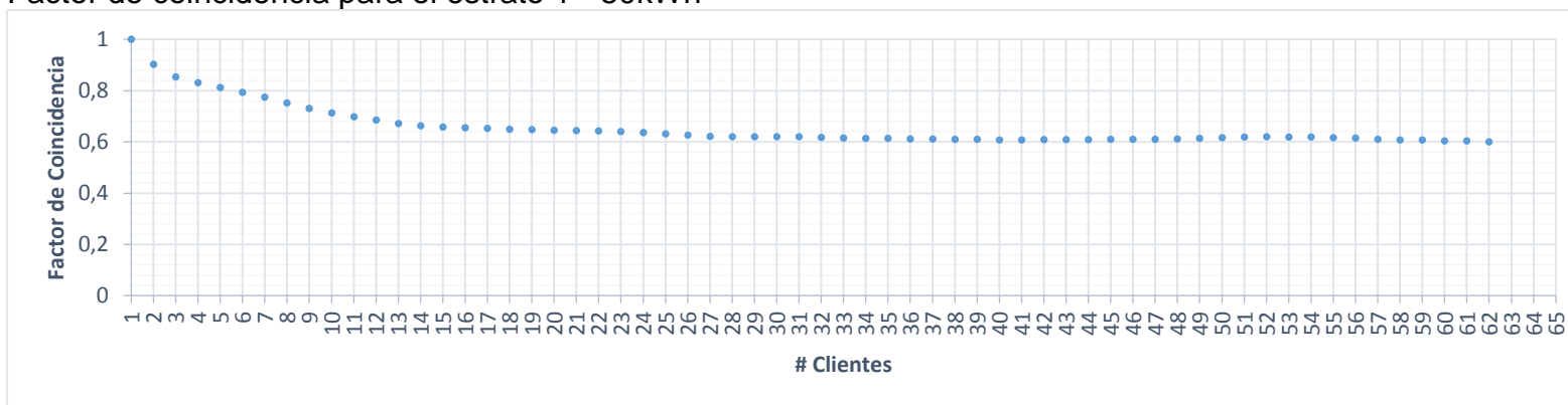
Figura 4.6 Factor de coincidencia para el estrato 1 - 50kWh.
