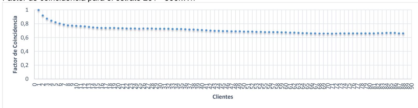
Figura 4.9 Factor de coincidencia para el estrato 201 - 500kWh. Fuente: Elaboración propia.
