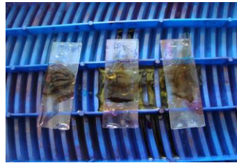
Foto 4. Luego del lavado se coloca el ácido sulfúrico
