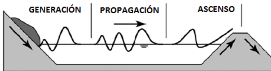
Figura 1.3. 2 Fases de una ola generada por deslizamientos. [13]
