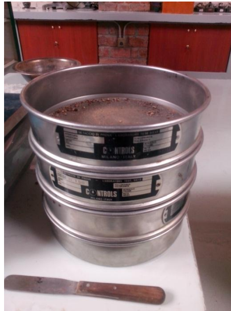
Figura 3.5. Material procedente del lavado de finos y secado al horno.
