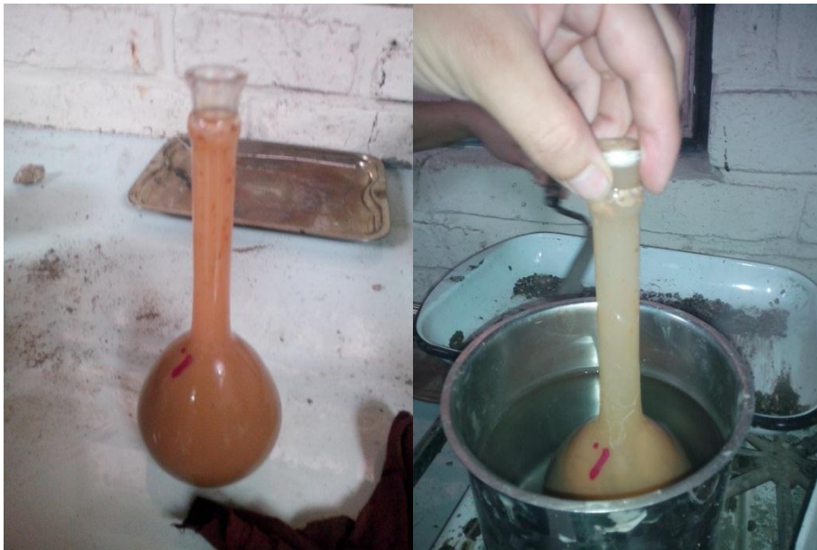
Figura 3.3. Ensayo de Gravedad Específica sobre la muestra de suelo.
