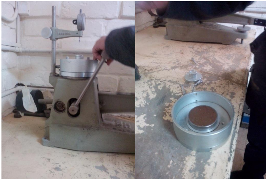
Figura 3.14. Colocación de la muestra en el anillo y en el consolidado metro.
