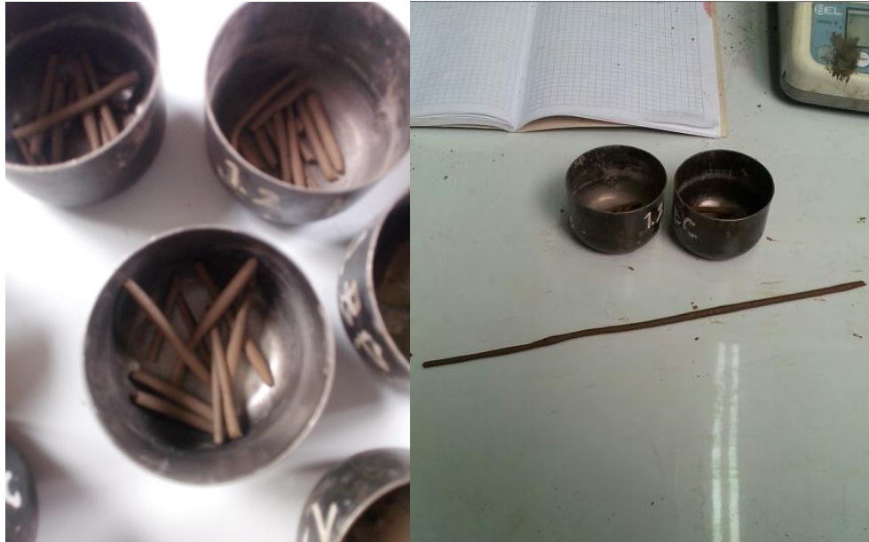
Figura 3.6. Ensayo del Límite de Plasticidad y muestras para determinar la humedad.
