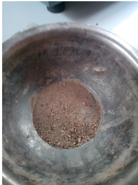
Figura 3.4. Material procedente del lavado de finos y secado al horno.
