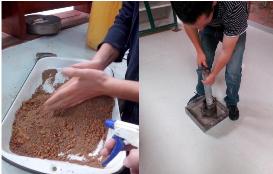
Figura 3.8. Preparación y Compactación del Suelo.
