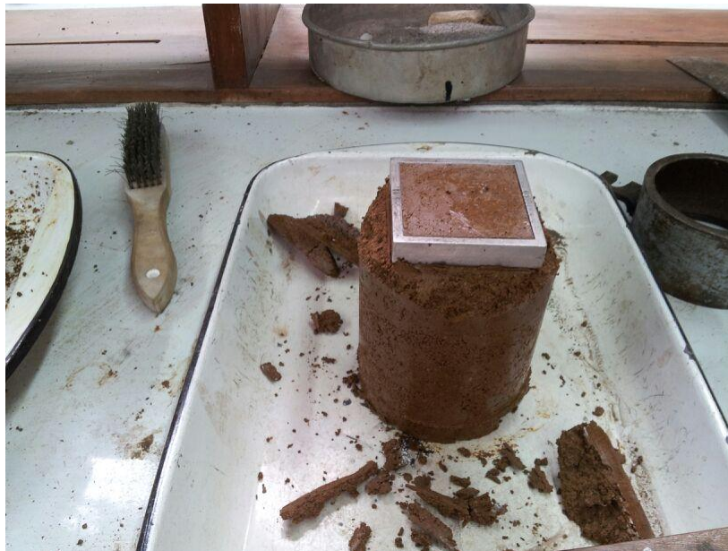
Figura 3.10. Extracción de la muestra para ensayo de corte directo a partir de la probeta resultante del ensayo Proctor Estándar.
