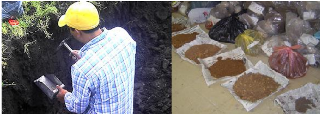
Figura 3-3 Toma de muestras alteradas.
