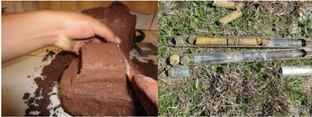
Figura 3-2 Toma de muestras inalteradas.
