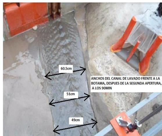
**Fotografía 16. Medición del ancho del canal a los 90 minutos de la segunda apertura**
