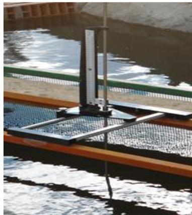
**Fotografía 10. Limnómetro instalado en el ingreso al tramo del río Jubones**
