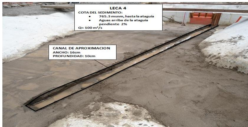
Fotografía 33. Vista posterior del embalse antes del ensayo LECA 4
