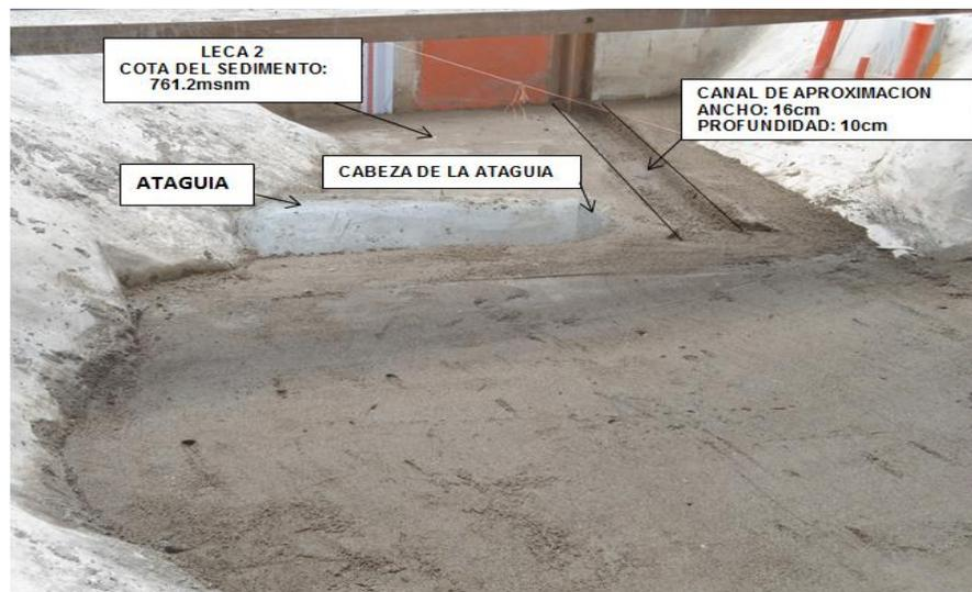
**Fotografía 28. Vista posterior del embalse antes del ensayo LECA 2**
