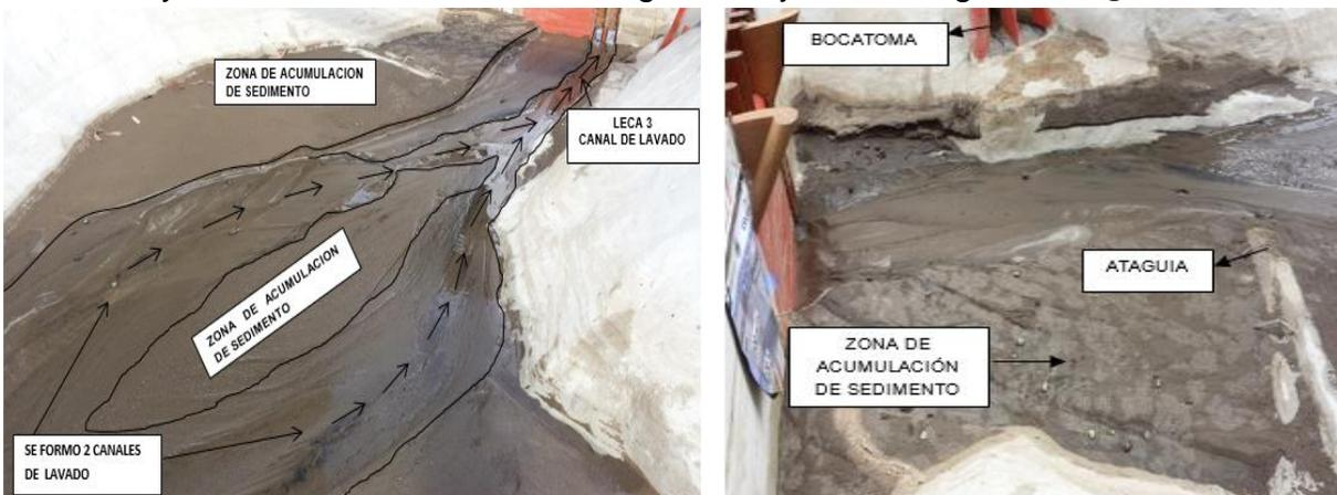
**Fotografía 32. Condición del embalse al finalizar el ensayo.**
