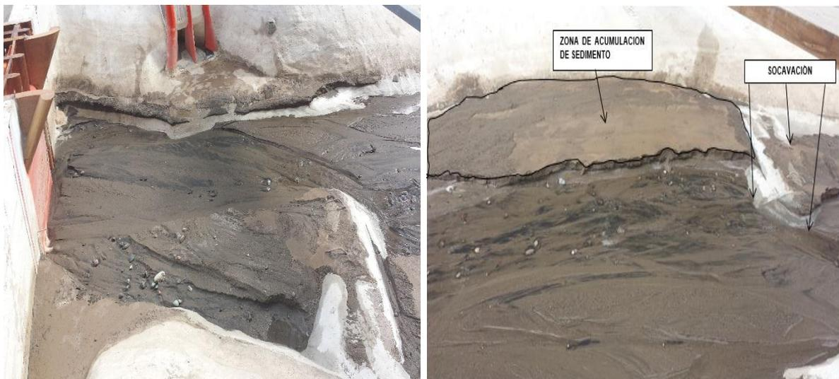
**Fotografía 35. Condición del embalse al finalizar el ensayo**
