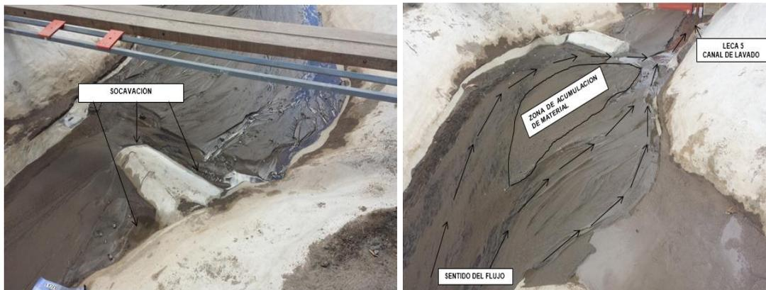
**Fotografía 39. Condición del embalse al finalizar el ensayo**
