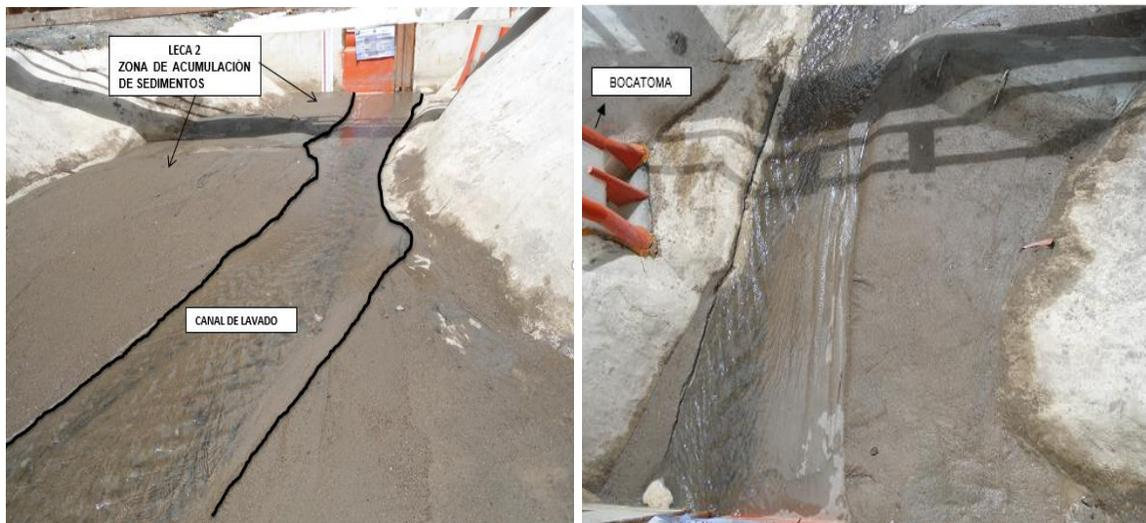
**Fotografía 29. Condición del embalse al finalizar el ensayo**
