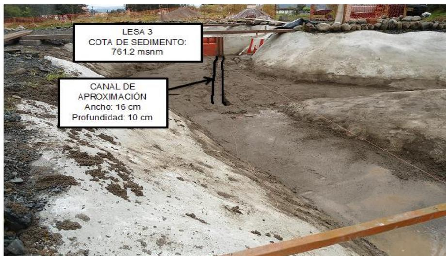
**Fotografía 22. Vista posterior del embalse antes del ensayo LESA 3**
