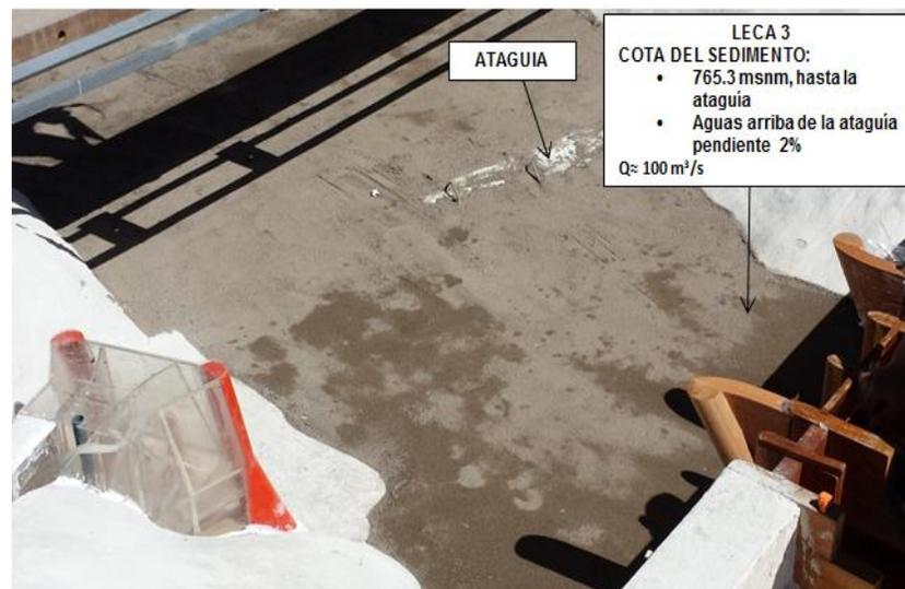
**Fotografía 30. Vista lateral del embalse antes del ensayo LECA 3**
