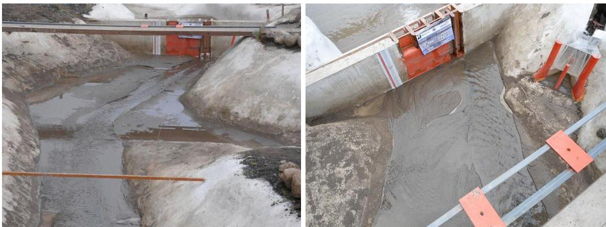
Fotografía 24. Condición del embalse al finalizar el ensayo
