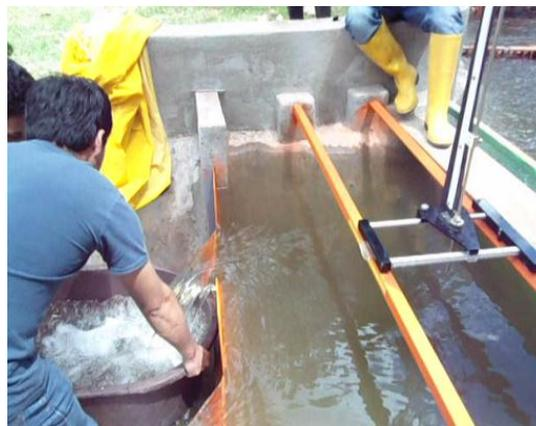
**Fotografía 13. Aforo volumétrico de los vertederos de Ingreso al tramo del río Jubones**
