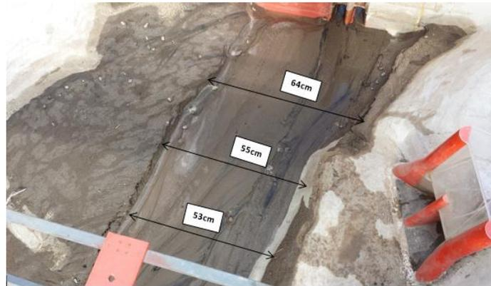
**Fotografía 31. Medición del ancho del canal frente a la bocatoma**
