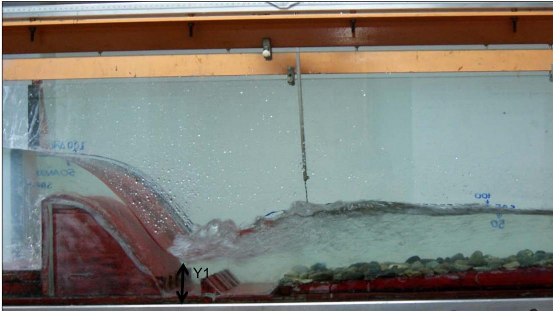
Tenemos también el GRAFICO 5-2 correspondiente al caudal de diseño y la posición 3, con un valor de  $z$  estimado en 13 cm ,produciéndose un aumento en la altura de caída y por consiguiente una disminución en el parámetro  $y_1$ .
