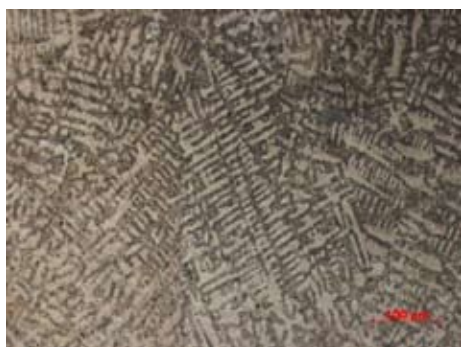
Рис. 5. Микроструктура сплава 1 в литом состоянии. х200
