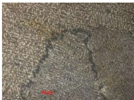
Рис. 6. Микроструктура сплава 2 в литом состоянии. х200
