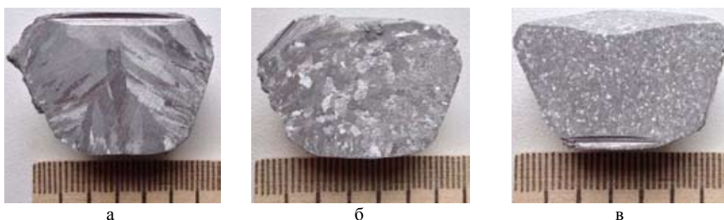
Рис. 4. Макроструктура алкан-теста проб сплава АВЕ: а – без модифицирования; б – модифицированного АITi5B1; в – модифицированного МС-М
