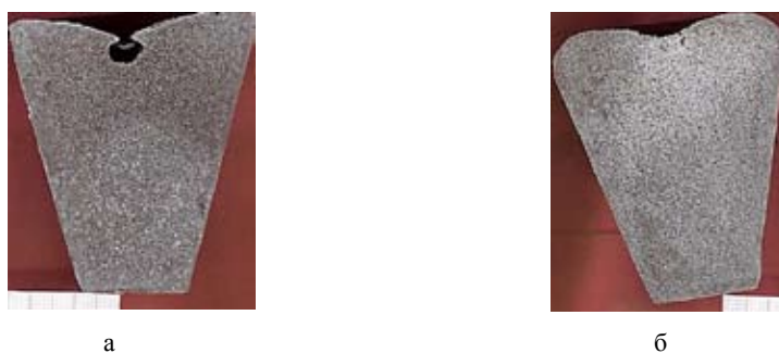
Рис. 3. Макроструктура проб ALCAN-TEST в долевом направлении после модифицирования AlTi5B1 (а) и флюсом COVERAL MTS1582 (б)
