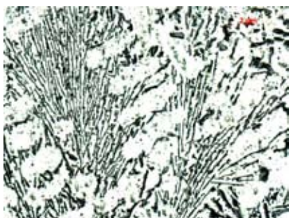
Рис. 4. Микроструктура сплава АК12 в термообработанном состоянии ( T_3 = 580 °С, \tau = 5 мин, охлаждение на воздухе)
