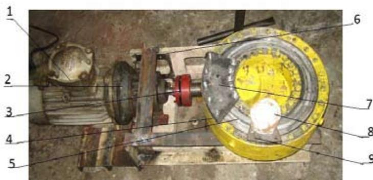
Рис. 2. Общий вид установки СЛиК: 1 – электродвигатель переменного тока; 2 – редуктор; 3 – соединительная муфта; 4 – корпус установки; 5 – кристаллизатор, прикрепленный к корпусу болтами; 6 – рама; 7 – башмак с матрицей; 8 – заливная воронка; 9 – дозатор
