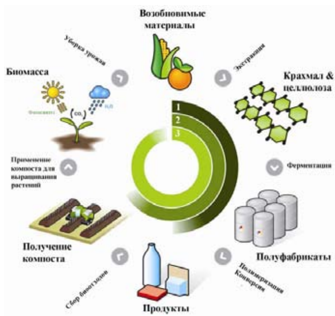
Рис. 1. Схема производства, потребления и утилизации полимеров, полученных из возобновляемых источников, включающая стадию компостирования: 1 – путь от сбора урожая до получения продукта; 2 – путь от сбора урожая до утилизации биополимеров; 3 – путь от сбора урожая до сбора урожая (Kijchavengkul, Auras, 2008)
