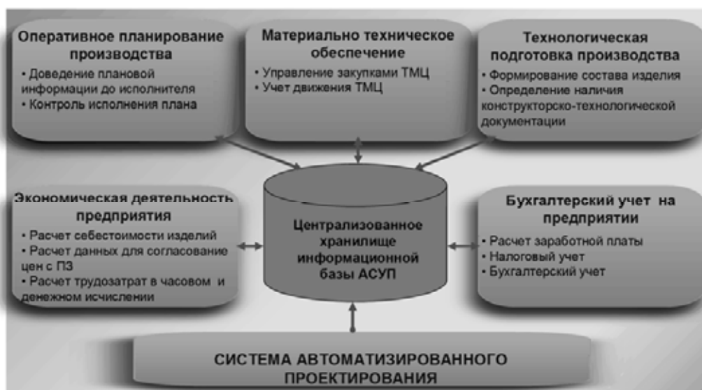
Рис. 2. Укрупненная структура комплексной автоматизированной системы управления предприятием ОАО «НПП «Радиосвязь»
