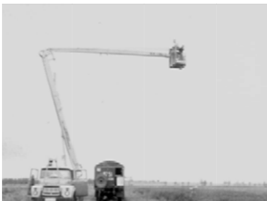
Рис. 1. Дистанционная регистрация спектральных коэффициентов яркости посевов агроценозов спектрофотометром, установленным в корзине автовышки
