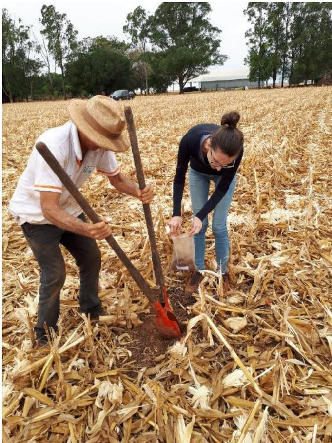
**Abbildung 14.** Entnahme einer Probe des Oberbodens auf einem Betrieb bei Nova Mutum, Mato Grosso, Juli 2019. Die Probenahme fand kurz nach der Körnermisernte statt, weswegen der Boden mit Ernteresten bedeckt war. Diese wurden für die Probenahme vollständig beiseite gewischt. Auf diese Weise wurden von zehn Punkten pro Standort bis in 10–15 cm Tiefe Bodenproben entnommen und als Mischprobe in eine Plastiktüte abgefüllt.
