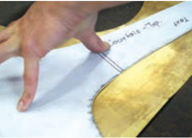
[207] Zuschnitt eines Trompetenschallstücks, ein erster Schritt hin zum Nachbau der Natur-, Zug- und Ventiltrompeten von Antoine Courtois durch die Firma Egger, Basel. Diese baut in historischer Fertigungsweise und aus einem Messing, der die am Original festgestellte, bleihaltige Legierung aufweist (Foto Sarah Leonor Müller).
