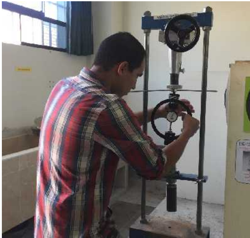
Fotografía 7: Calibración de Marco De CBR
