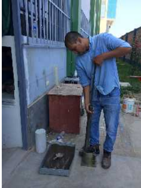
Figura 3.15: Aplicación de 56 golpes por capa en el molde para el ensayo del proctor.
