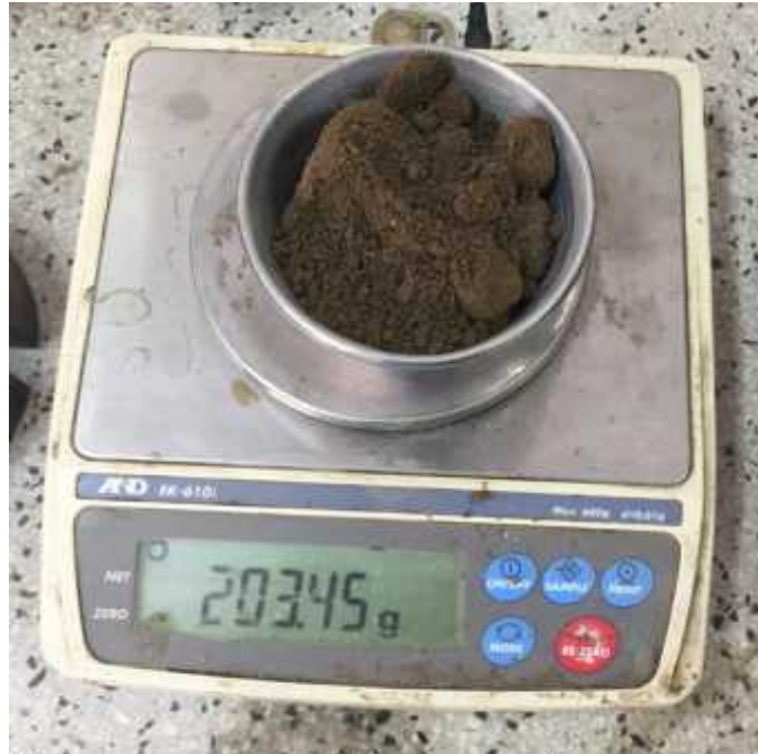
Figura 3.17: Se extrae una muestra del proctor para obtener su contenido de humedad
