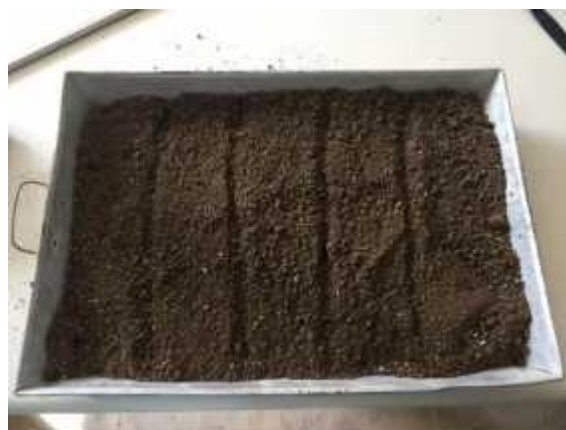
Figura 3.14: 5.5 Kg. De muestra para vaciar en el molde del proctor.
