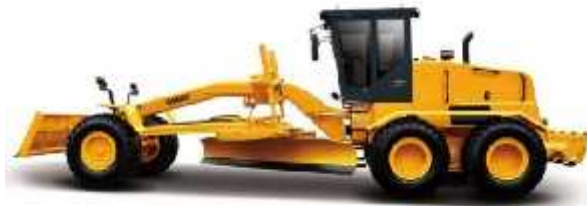
Figura 1.3: Motoniveladora. (Smac). Fuente: Internet.
