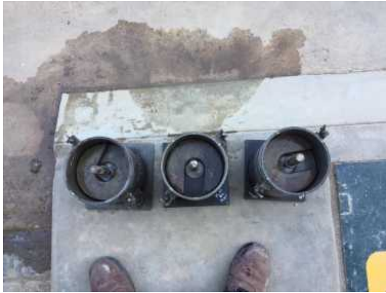
Figura 3.25: Moldes para su respectiva penetración del ensayo.
