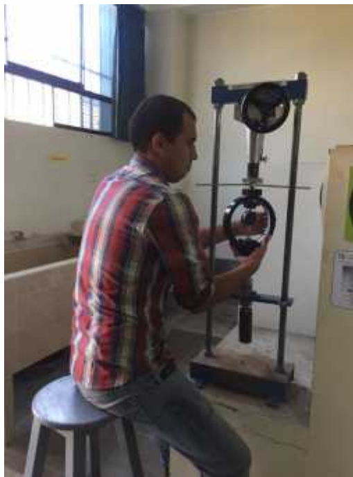
Figura 3.27: Marco de ensayo CBR
