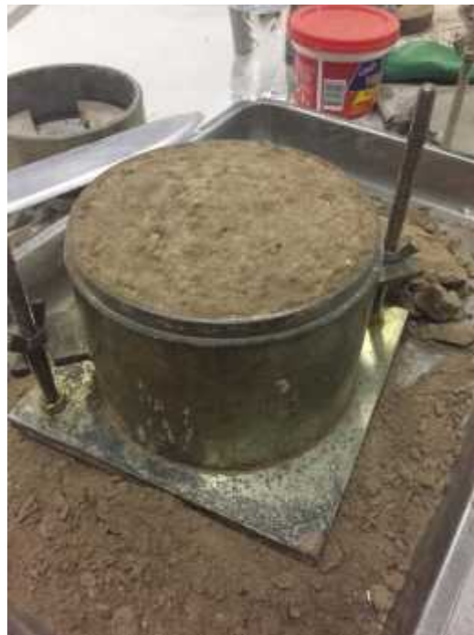
Figura 3.16: Toma del peso del molde con el suelo compactado.
